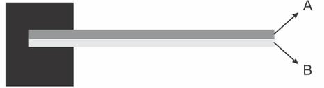
Considere que ambas as lâminas estão inicialmente sujeitas à mesma temperatura  $T_0$ , e que a relação entre os coeficientes de dilatação linear seja  $\alpha_A > \alpha_B$ .
